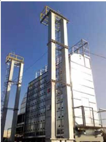
ния с мишметаллом специальным методом (galvan), обладающая повышенной стойкостью к коррозии;
